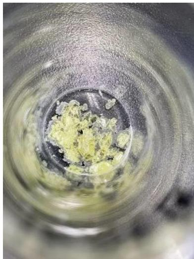
図2 30度で析出させた低純度硫黄の板状結晶
