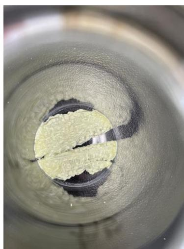
図4 二硫化炭素より析出させた低純度硫黄の結晶
