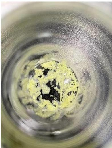
図1 常温で析出させた低純度硫黄の樹状結晶
