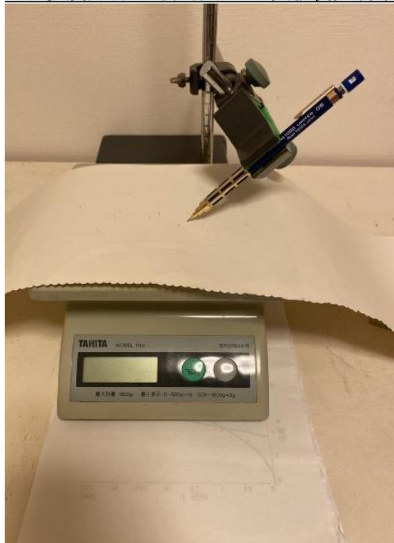
**芯の強度計測の為、作成した実験装置(改良後)**
