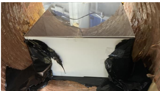
写真4. 明条件 (室内灯条件) 下での観察のためにプラスチック板と暗幕を取り付けた行動観察容器
